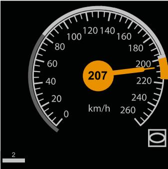
la vitesse maximale autorisée est dépassée. La vitesse doit être réduite par le MEC.
