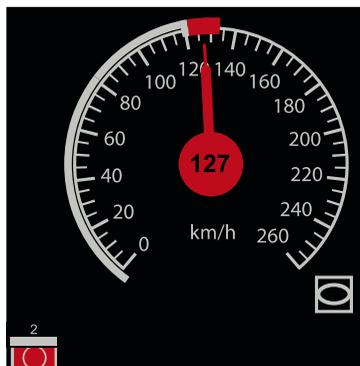
la vitesse maximale autorisée est dépassée. La vitesse est réduite automatiquement au moyen du serrage par le système ou il en résulte un serrage imposé.
